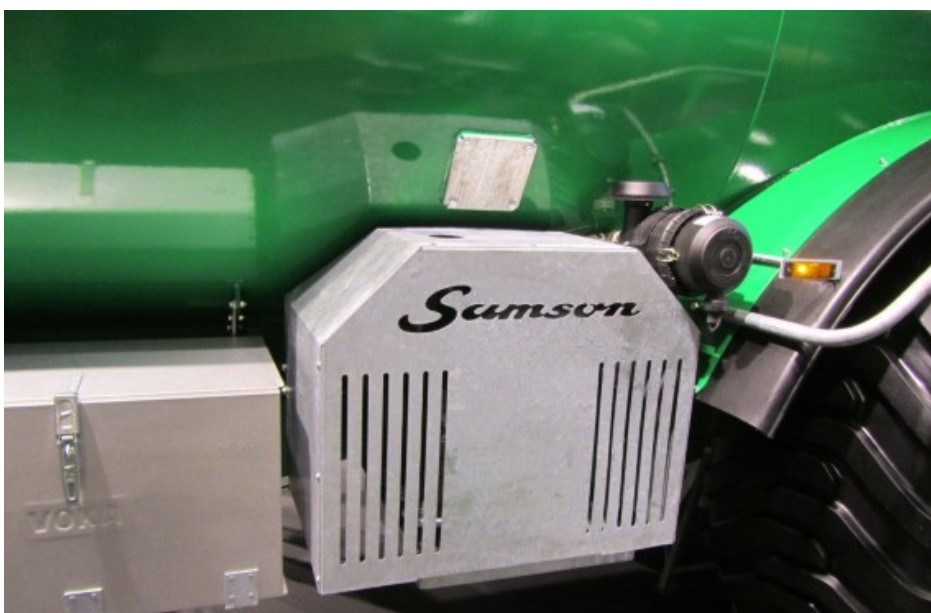
Billede 3. Montage af et system til dæktryksregulering sænker brændstofforbruget og minimerer strukturskader. Foto: Henning Sjørlev Lyngvig, VFL.
