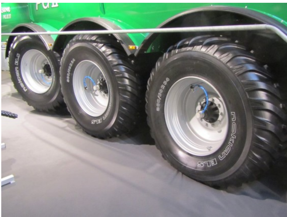
Billede 3. Montage af et system til dæktryksregulering sænker brændstofforbruget og minimerer strukturskader. Foto: Henning Sjørlev Lyngvig, VFL.
